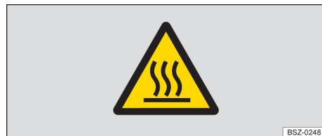
Bilde 7 Varselskilt for varme overflater på laderen.
