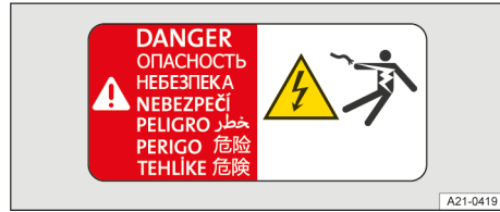
Bilde 4 Varselskilt på høyvoltkomponenter.
