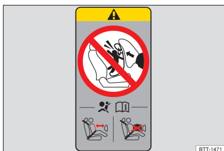
Bilde 2 Merkelapp for kollisjonspute på A-stolpen eller B-stolpen (eksempel).
